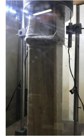
iii) Fibre Rupture
