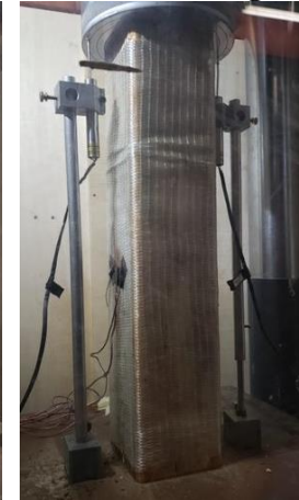
ii) Wood Crushing
