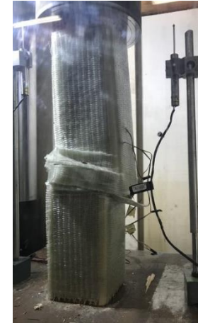
iii) Fibre Rupture
