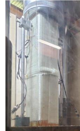
iii) Fibre Rupture
