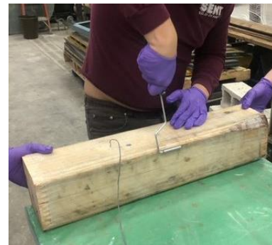
(d) Eliminating Air Pockets or Slack with Ribbed Roller
