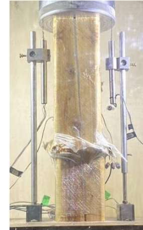
iii) Fibre Rupture
