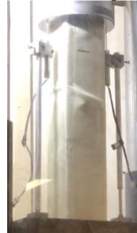
ii) Crushing Initiates
