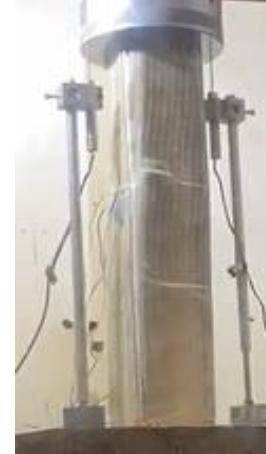
ii) Initial Crushing
