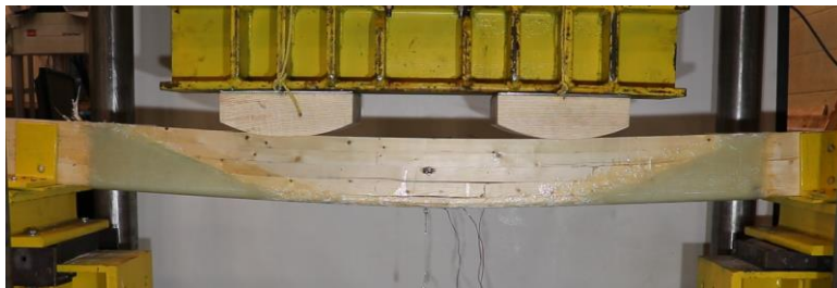
(3) Wood tensile failure
